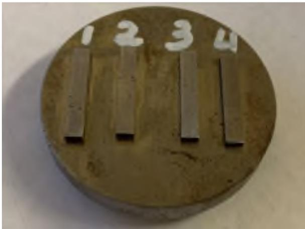
Рис. 1. Образцы электродов-инструментов
