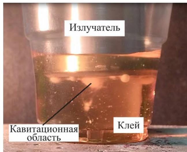
Рис. 2. Ультразвуковая обработка клея
