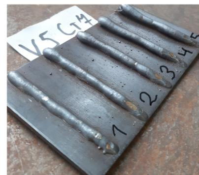
Рис. 1. Схема процесса наплавки валиков (а) и пластина с наплавленными валиками (б)
