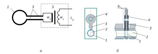
Рис. 1. Одновитковый ЧЭ кольцевого типа: схематическое представление (a) и пример конструкции, установленной в масляный канал ДВК  $(\delta)$ : 1 — ЧЭ, 2 — отверстие масляного канала ДВК, 3 — тоководы, 4 — место для установки согласующего трансформатора, 5 — согласующий трансформатор
