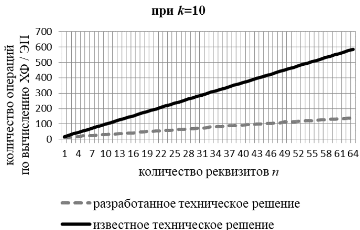
Рис. 12. Результат оценки количества операций вычисления ХФ/ЭП в зависимости от количества совершаемых преобразований в течение жизненного цикла ЭЛД
