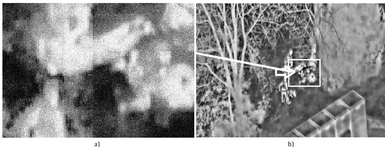
Рис. 3. Результат обработки зашумленного ИК изображения: исходная локальная часть (а) и обработанное изображение (b) Fig. 3. The Result of Processing a Noisy IR Image: the Original Local Part (a) and the Processed Image (b)
