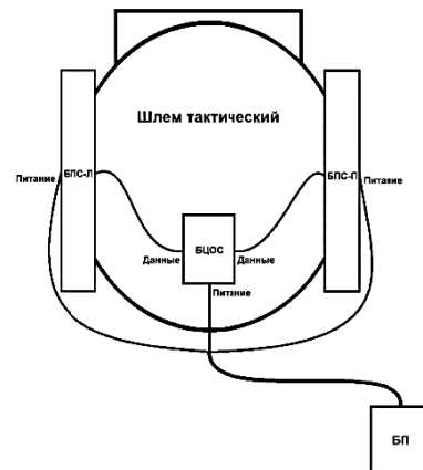
Рис. 2. Схематическое расположение блоков устройства на тактическом шлеме
