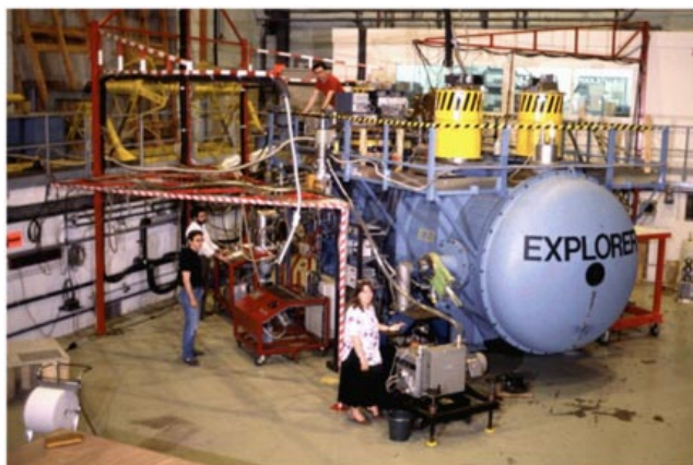
Рис. 3. Резонансный детектор Explorer (ЦЕРН, Швейцария).
