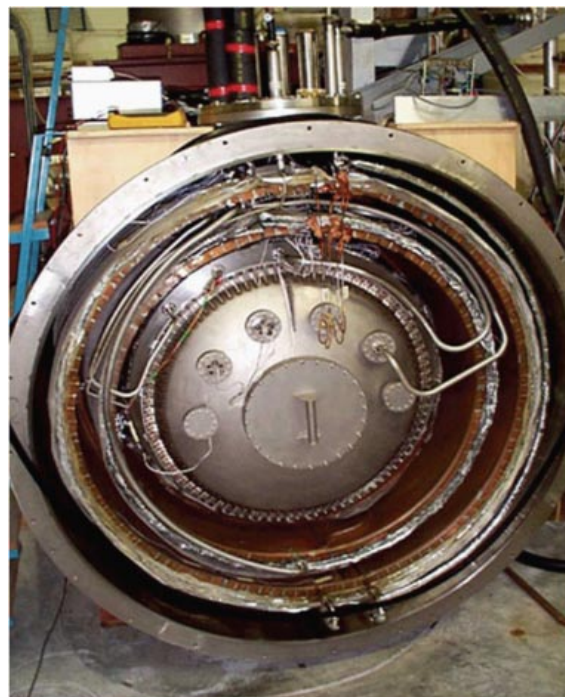
Рис. 5. Резонансная гравитационная антенна Niobe. Цилиндрическая антенна изготовлена из ниобия. Находится в Университете Западной Австралии в г. Перте (Perth).
