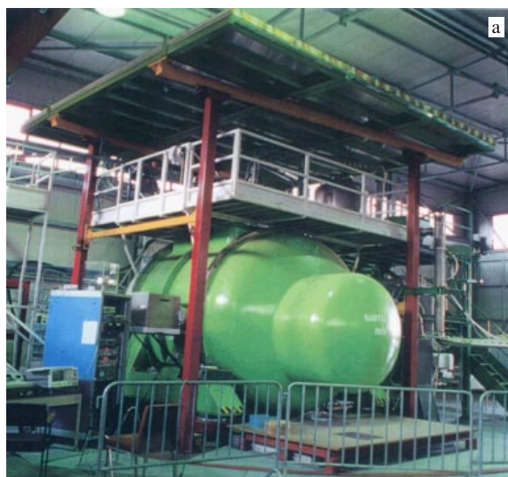
Рис. 6. Резонансные гравитационные антенны Nautilus (а) и AURIGA (б).
