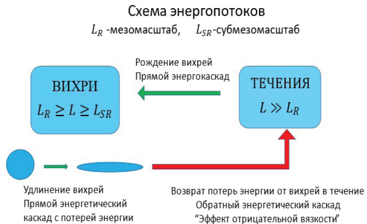
Рис. 2. Схема обмена энергией между течением и вихрем при вытягивании вихря.
