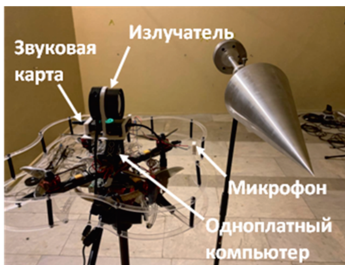
Рис. 2. Пример дифракционного эксперимента с прототипом летательного аппарата.
