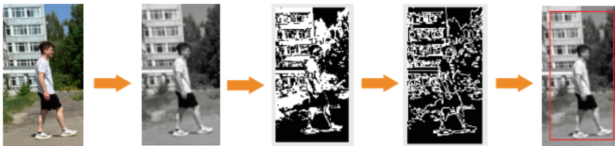
Рис. 8. Принцип работы алгоритма распознавания человека на изображении.
