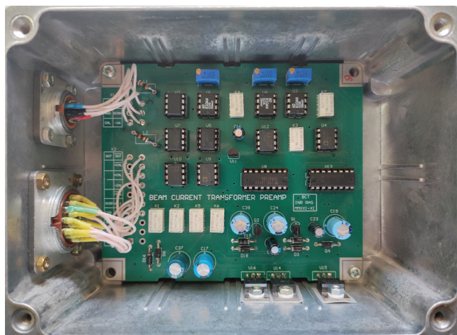
Рис. 4. Фотография изготовленного предварительно-го усилителя ИДТ.
