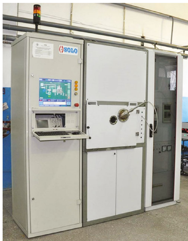
Рис. 1. Схема обработки в импульсной электронно-лучевой установке (а) и внешний вид установки "СОЛО" (ИСЭ СО РАН) (б): 1 — плазменный катод; 2 — электронный пучок; 3 — линза; 4 — кварцевое стекло; 5 — оптоволоконный кабель; 6 — образец; 7 — термопара; 8 — стол-манипулятор; 9 — мультиметр; 10 — высокоскоростной инфракрасный пирометр; 11 — осциллограф.
