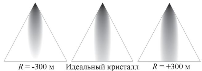
**Рис. 5.** Численное моделирование волнового поля в треугольнике рассеяния в случае толстого кристалла при разных знаках изгиба отражающих плоскостей.
