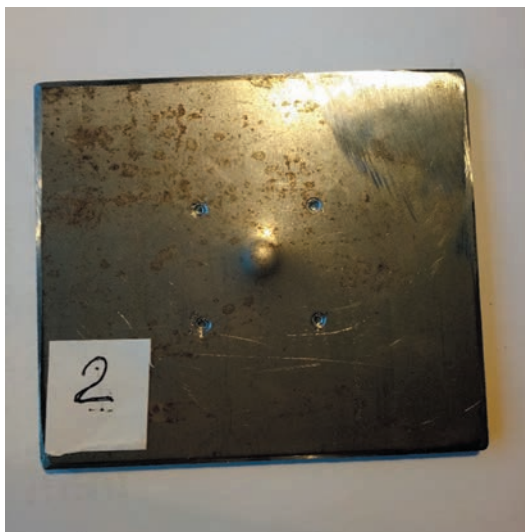
Рис. 4. Сплошная пластинка из стали после удара (эксперимент № 5).
