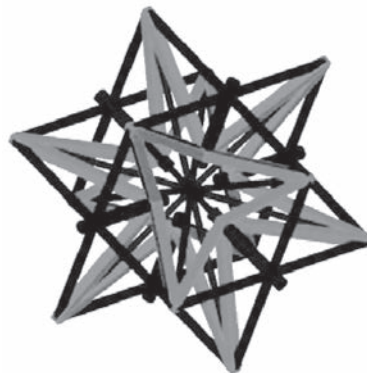
Рис. 12. Структура ячейки метаматериала с отрицательным коэффициентом теплового расширения.
