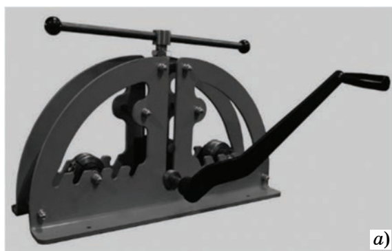
Фиг. 2. Фотография (а) и схема (б) трехвалковой машины с тремя вариантами межвалкового расстояния L_0
