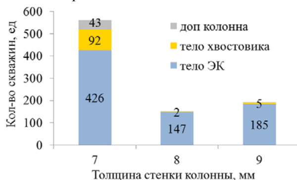
Рис. 3. Разрушение эксплуатационных колонн в различных толщинах стенок
