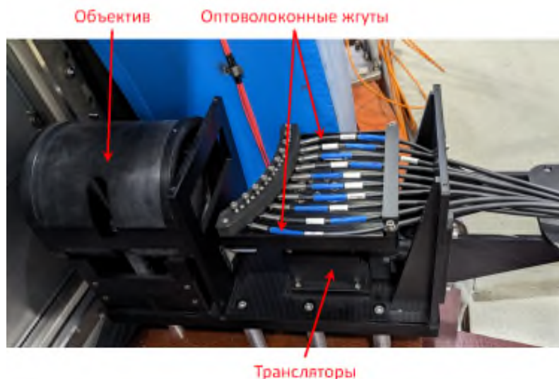
Рис. 3. Расположение узла сбора света на фланце токамака.
