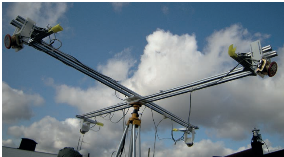
Рис. 12. Камеры КАМ-О/ЭМ (4 шт.) прибора ТСПП-ЭМ на стенде, имитирующем посадочную платформу КА Экзо-Марс-2022 в ходе испытаний в ИКИ РАН.
