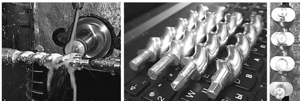
Рис. 7. Винтовые роторы, обработанные фрезами различного диаметра.
