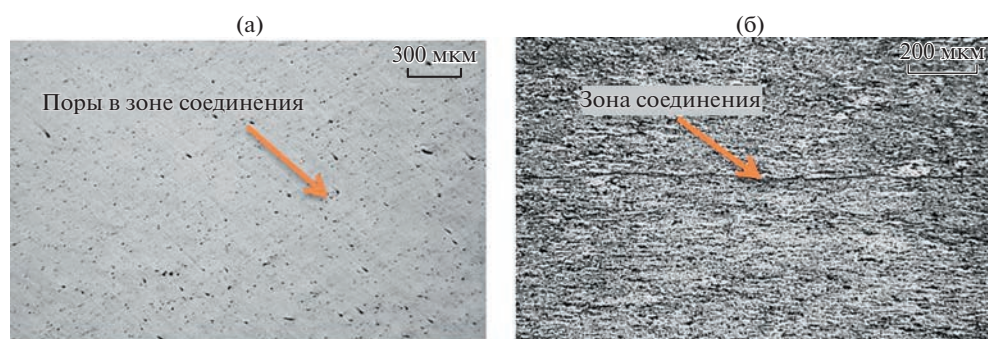
Рис. 6. Микроструктура зоны соединения заготовок из сплава АМг6: (а) – до травления; (б) – после травления.
