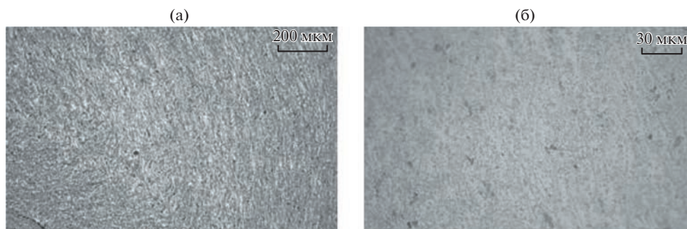
Рис. 3. Микроструктура в зоне соединения заготовок: (а) – X100; (б) – X500.
