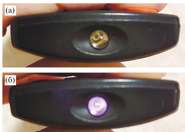
Рис. 1. Пример разного восприятия цвета глазом человека (а) и камерой (б). Излучение пульта находится в инфракрасном диапазоне, невидимом для человеческого глаза. Однако с помощью камеры этот сигнал можно зафиксировать.
