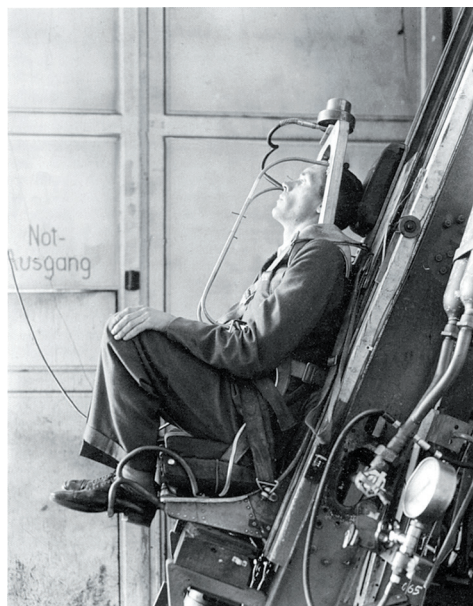
Катапультируемое кресло фирмы «Хейнкель» на испытательном стенде
