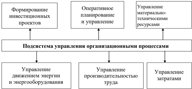
Рис. 4. Функциональная структура подсистемы управления организационными процессами
