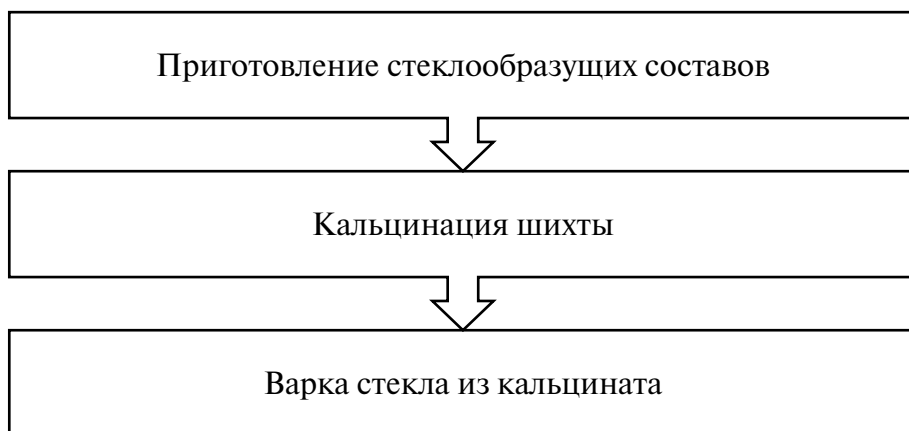
Рис. 2. Схема синтеза боросиликатных стекол в лабораторных условиях.
