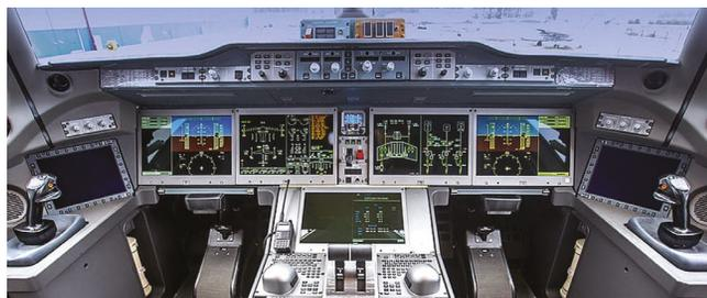
Рис. 1. Приборная панель самолета MC-21.
