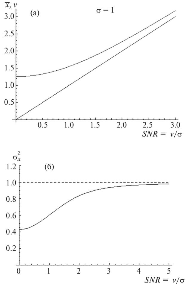
**Рис. 2.** Иллюстрация нелинейных свойств распределения Райса: (а) — нелинейная зависимость математического ожидания райсовской величины  $\bar{x}$  от райсовского параметра  $v$ ; (б) — нелинейная зависимость квадрата стандартного отклонения райсовского сигнала от дисперсии гауссовского шума  $\sigma^2$ , формирующего райсовскую случайную величину.
