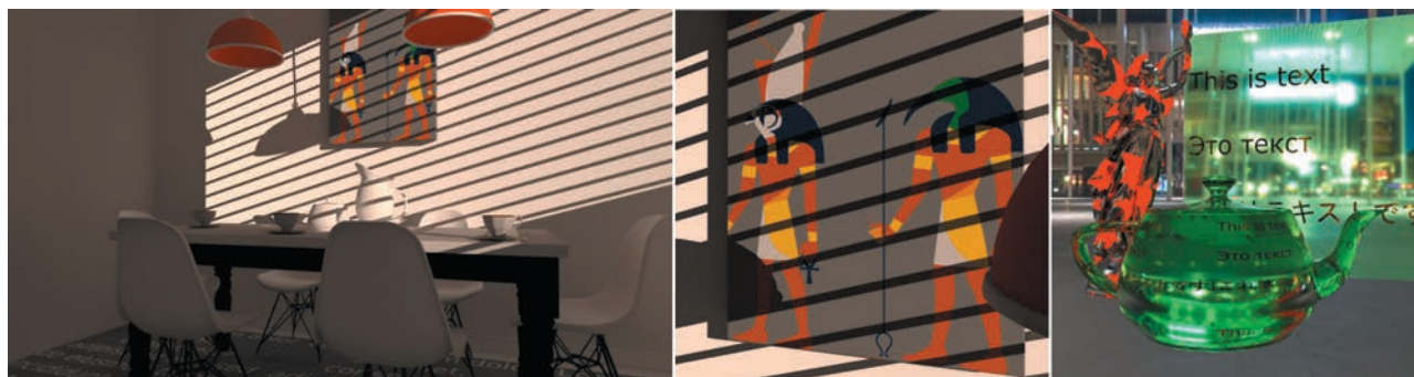
Рис. 1. Пример изображений, синтезированных системой фотореалистичного рендеринга с использованием предлагаемого решения. Слева – рендер сцены производился в разрешении FullHD, векторные изображения на картине и на полу. По центру – на этой же сцене камера была приближена к текстурированной картине и рендер был произведен в разрешении 8192 на 8192 без изменения векторной текстуры. Справа – векторные текстуры использовались как маски для смешения разных моделей материалов.
