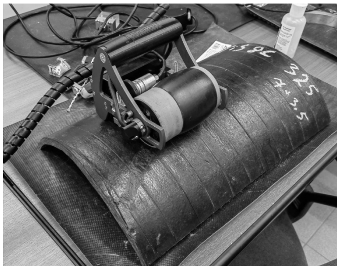
Рис. 1. Роликовый фазированный датчик с матрицей на 64 элемента.
