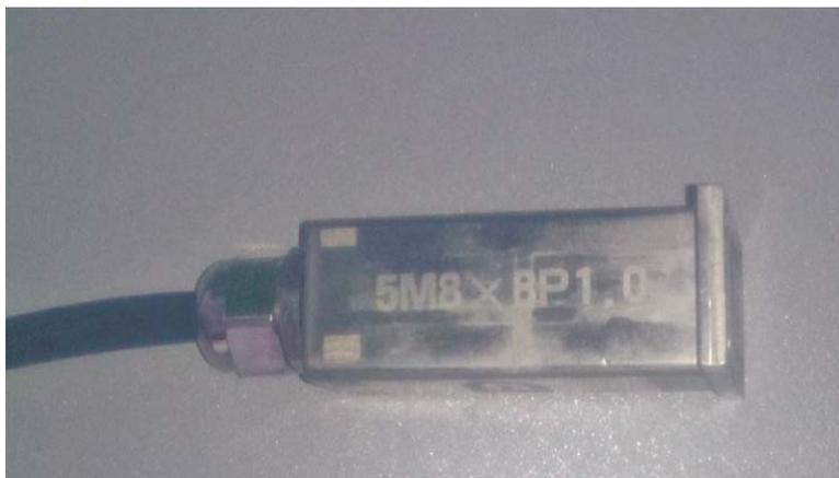
Рис. 2. Ультразвуковая матричная АР Doppler 5M8×8BP1.0.
