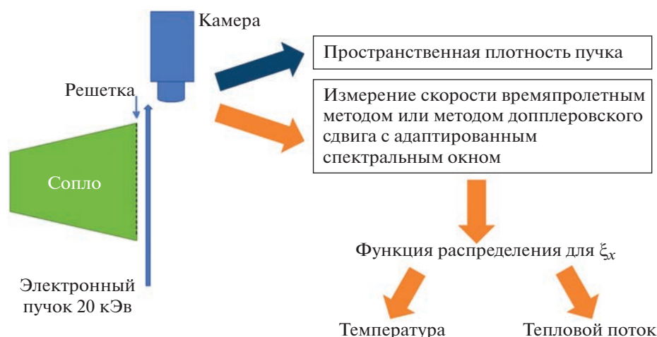
Фиг. 9. Схема экспериментальной установки. Слева показано сверхзвуковое сопло, сразу за ним — решетка, электронный пучок и камера, позволяющая регистрировать частицы.
