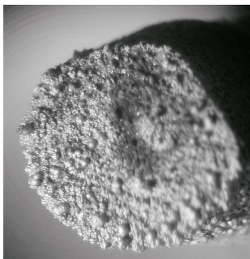
Рис. 5. Фотография разлома образца № 167 после воздействия дуги.
