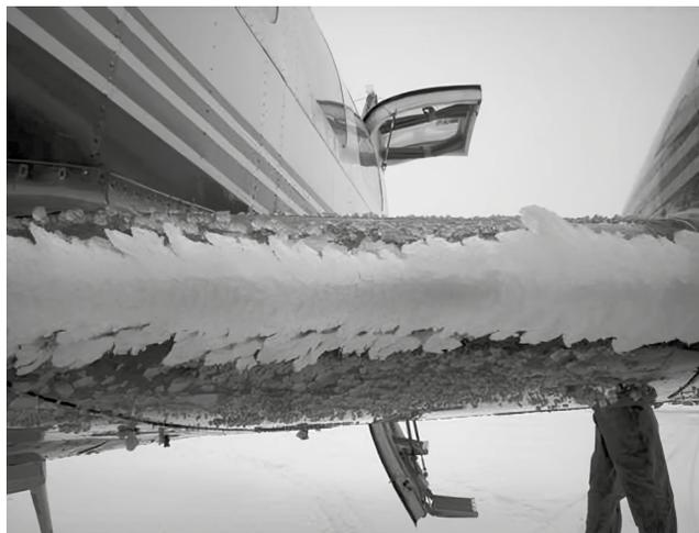
Рис. 1. Ледяные наросты типа “глянцевый лед”: (а) рогообразный [6], (б) “хвост омара” [7].
