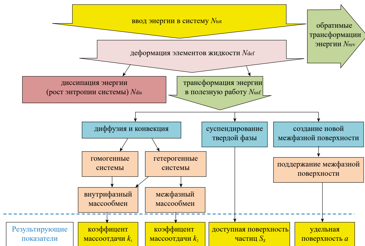
Рис. 4. Диаграмма преобразования энергии, вводимой в системы со сплошной жидкой фазой (жидкость-жидкость, жидкость-газ, жидкость-твердое) с учетом необходимости формирования межфазной поверхности.
