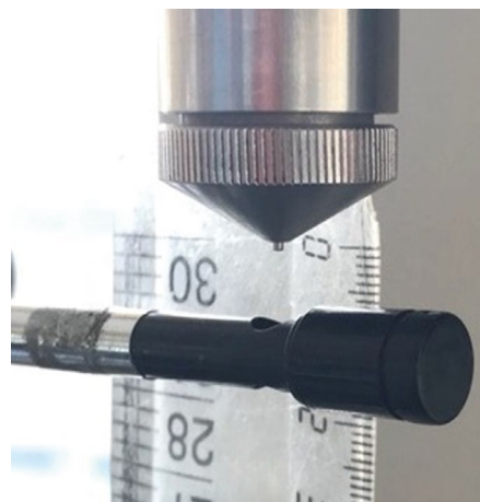
Рис. 8. Измерение скорости распыляющего воздуха.
