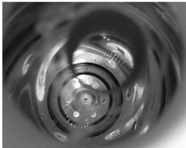
Рис. 2. Вид на внутренние элементы счетчика с торца. Нити на малом диаметре — первый катод, на большом диаметре — второй катод.
