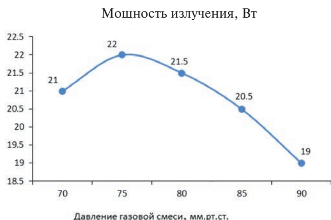
Рис. 14. Зависимость мощности излучения от давления газовой смеси (PWM = 100%).
