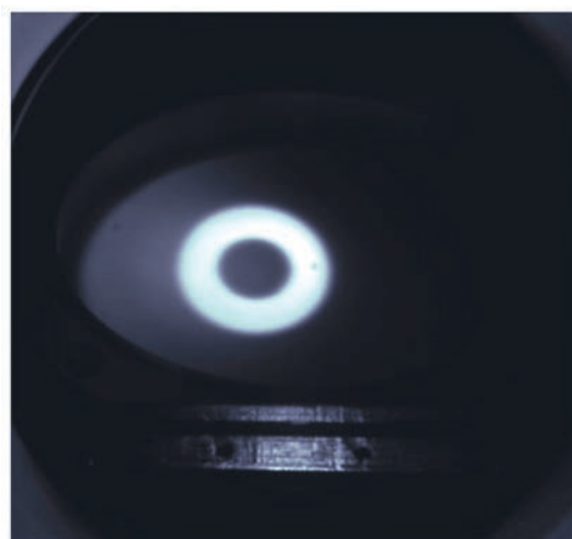
Рис. 7. Изображение свечения отпечатка пучка на обратной стороне флуоресцентного экрана Chromox с золотым напылением толщиной 300 нм.
