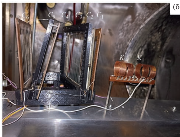
Рис. 2. Фотографии прототипа датчика вектора скорости микрочастиц, установленного в вакуумной камере ускорителя: а – вид сзади, б – вид сбоку.
