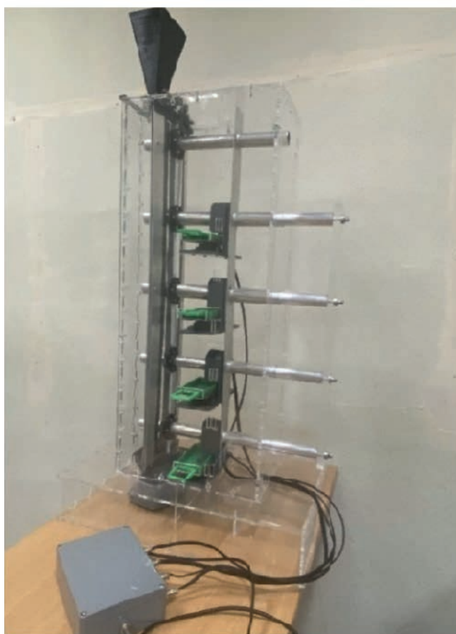
Рис. 1. Фото прибора-анализатора с четырьмя магнитоактивными блоками для контроля содержания магнитоактивных частиц в сыпучей среде.
