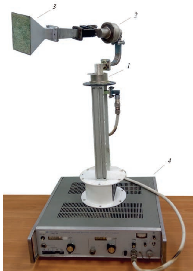
Рис. 4. Внешний вид макета наземного радиомаяка: 1 — ВВС1, 2 — ВВС2, 3 — РПА, 4 — ПРД (Г4-83).
