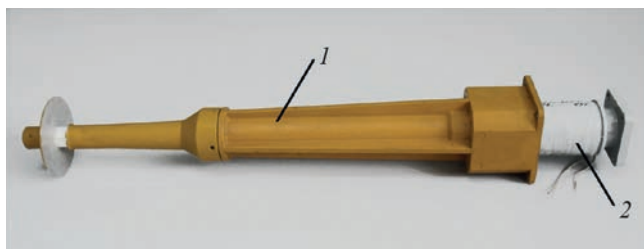
Рис. 5. Внешний вид штатного облучателя БЗПА с ФВПП: 1 — облучатель БЗПА, 2 — ФВПП.
