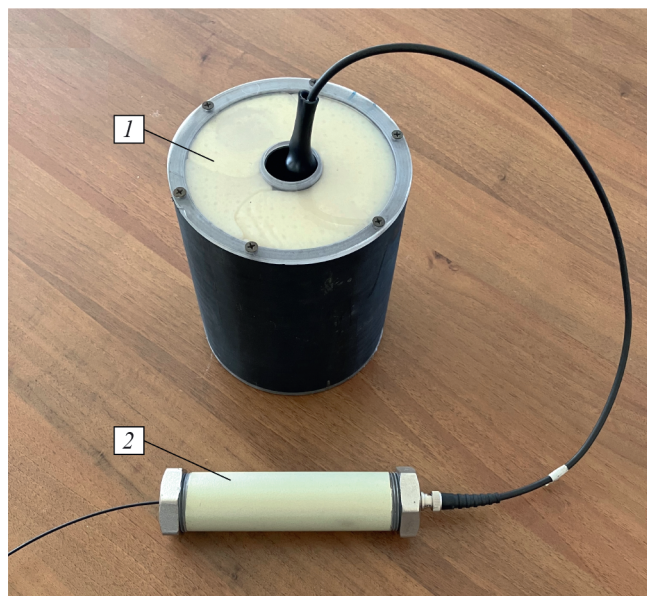
Рис. 2. Внешний вид детектора нейтронов: 1 – блок замедлителя нейтронов с СБМ-19, 2 – детектор импульсного нейтронного излучения.
