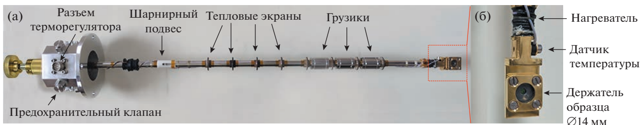
Рис. 4. Фотография нового штока (а) и увеличенное изображение держателя образца (б).
