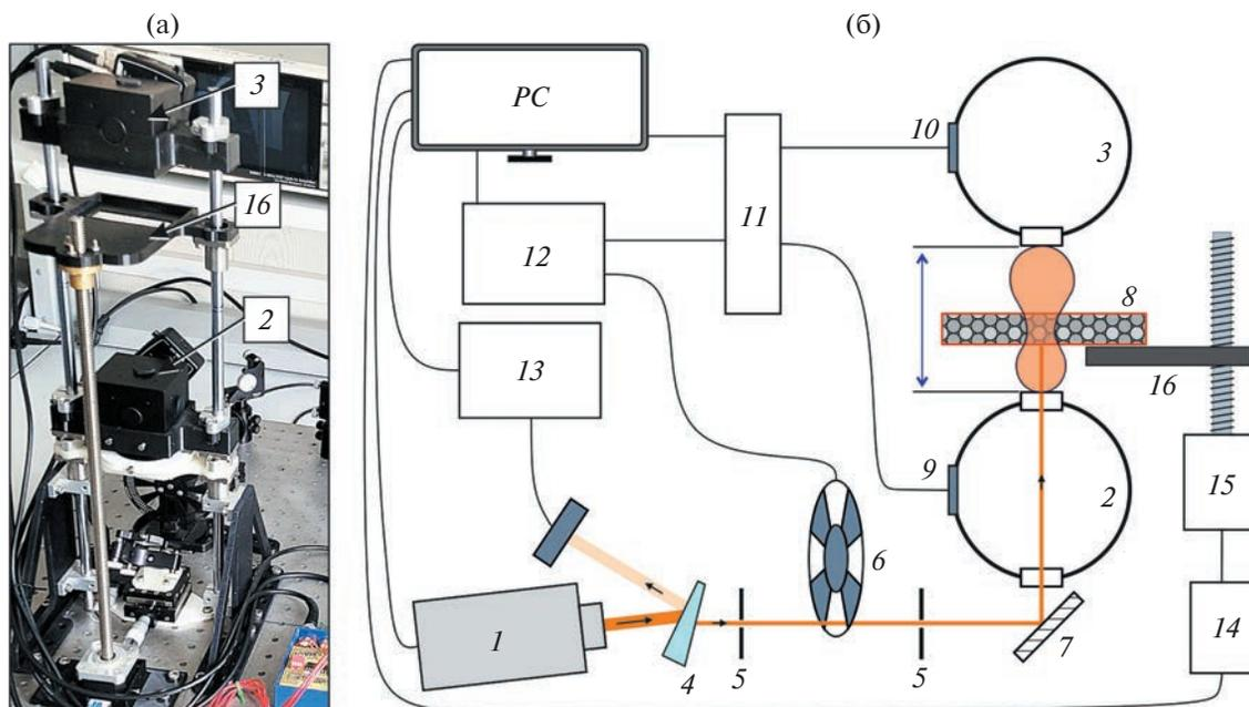
**Рис. 1.** Установка для определения оптических характеристик образцов биоткани: **а** – фрагмент общего вида; **б** – схема установки. 1 – лазерный источник; 2, 3 – интегрирующие сферы; 4 – клин; 5 – диафрагмы; 6 – чоппер; 7 – зеркало; 8 – образец биоткани; 9, 10 – фотодетекторы; 11 – мультиплексор; 12 – синхронный детектор; 13 – измеритель мощности; 14 – плата управления; 15 – шаговый двигатель; 16 – платформа.
