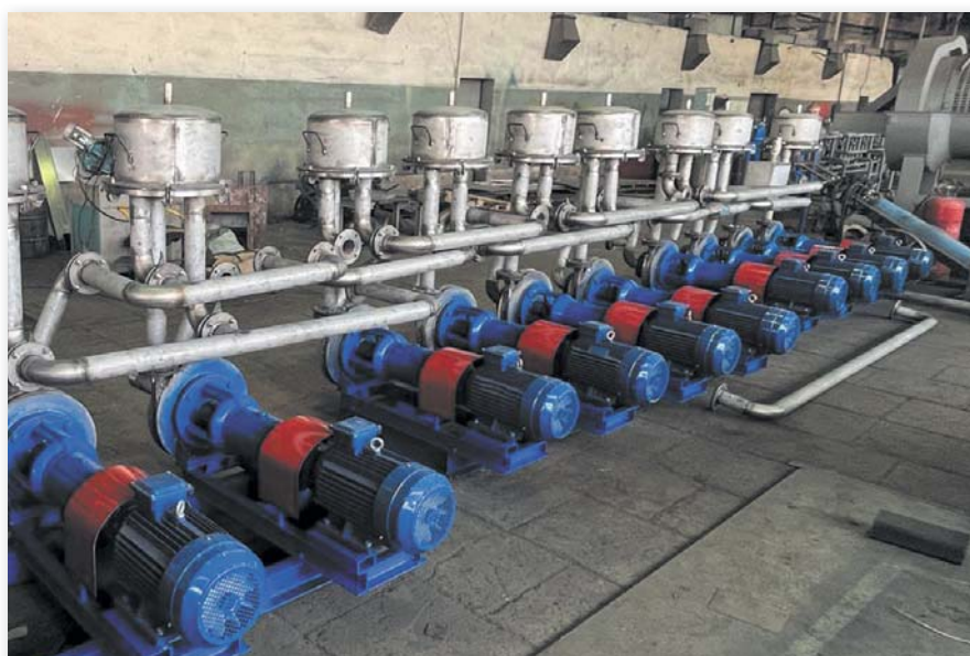
Мультициклонная установка производства ВНИИ крахмала и переработки крахмалосодержащего сырья
