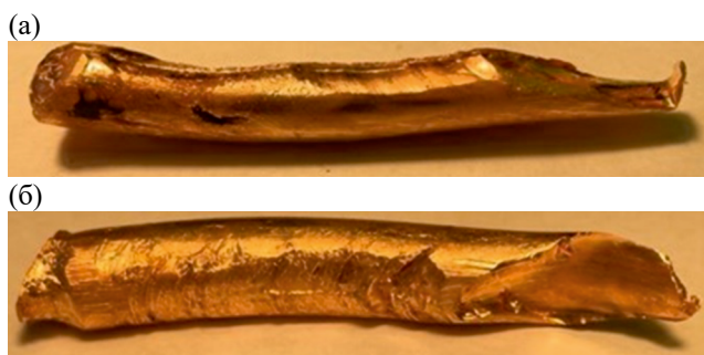
Рис. 2. Внешний вид образцов хромографниевой бронзы после 1 (а) и 2 (б) проходов ДКУП.
