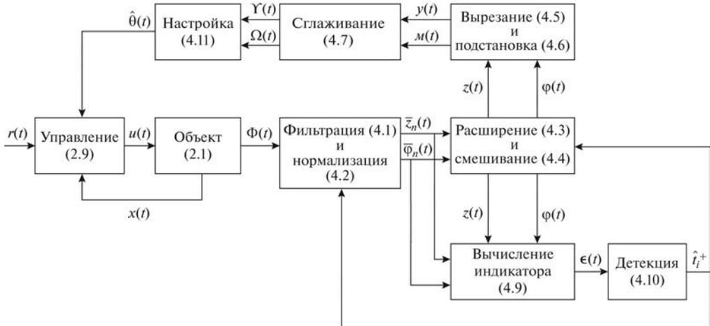
Рис. 1. Структурная схема разработанной адаптивной системы.
