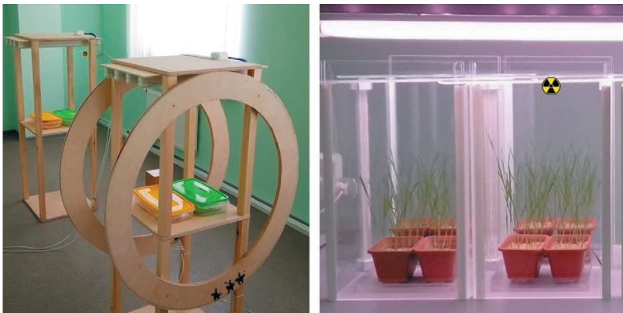
Рис. 2. Установки для моделирования повышенного уровня магнитного поля (слева) и радиационного фона (справа).
