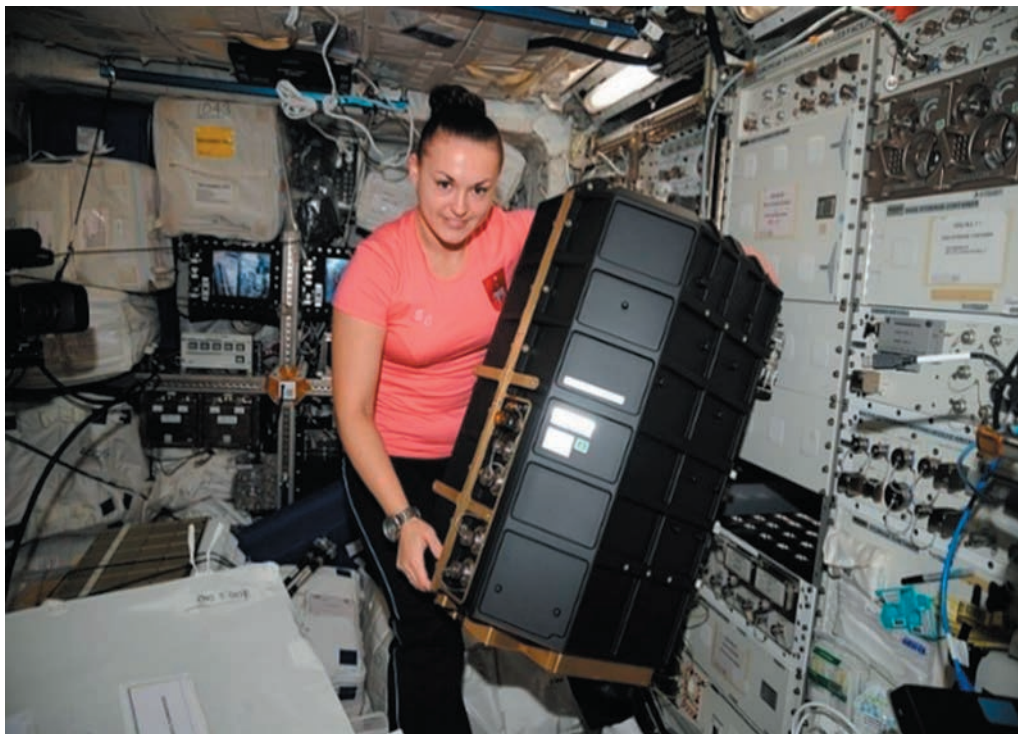
Рис. 12. Космонавты Елена Серова и Александр Самокутяев (фотографирует) монтирует экспериментальную камеру ПК-4 массой 100 кг в европейском модуле Колумбус на борту МКС (Роскосмос-ЕКА, ноябрь 2014 г.).
